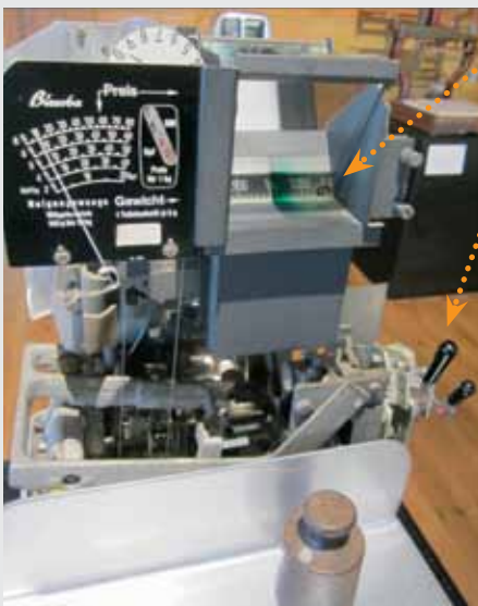
Balance à double contrepoids pendulaire avec affichage optique du prix (OP)
