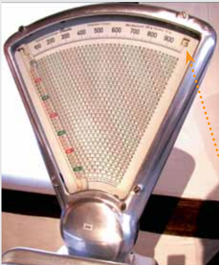
Balance automatique à commutation de masses avec échelle d'affichage du prix
