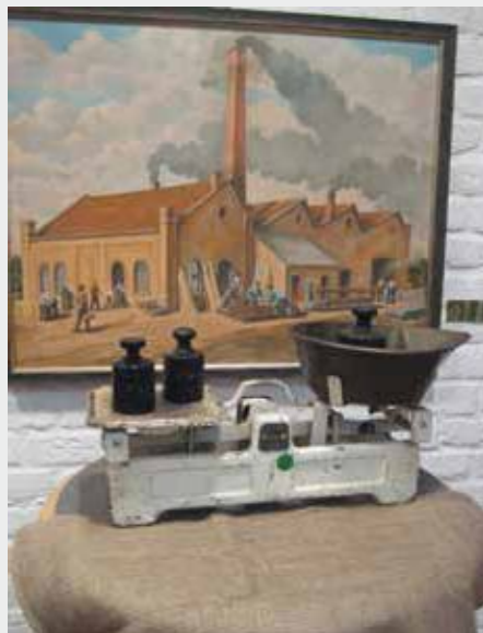
Die Tafelwaage arbeitet nach dem Prinzip der gleicharmigen Balkenwaage.
