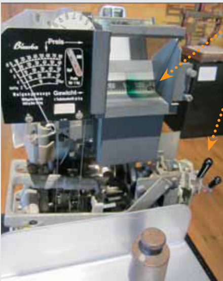
Doppelpendel-Neigungswaage mit Optischer Preisanzeige (OP)
