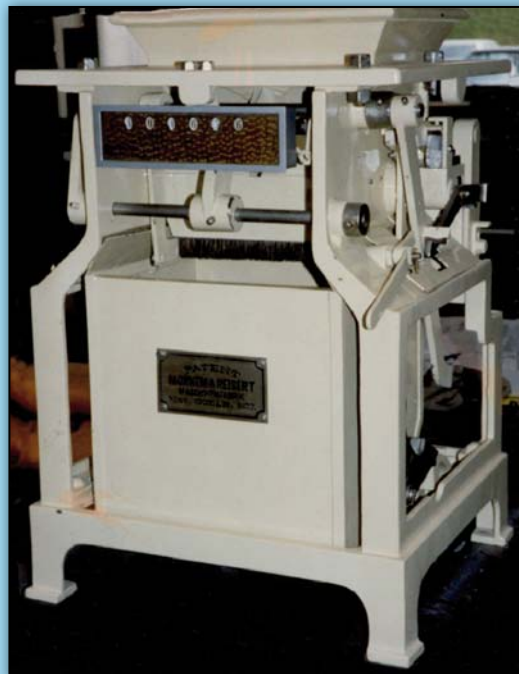
Reiser's Durchsatzmeßgerät für lose Schüttgüter von 1877
